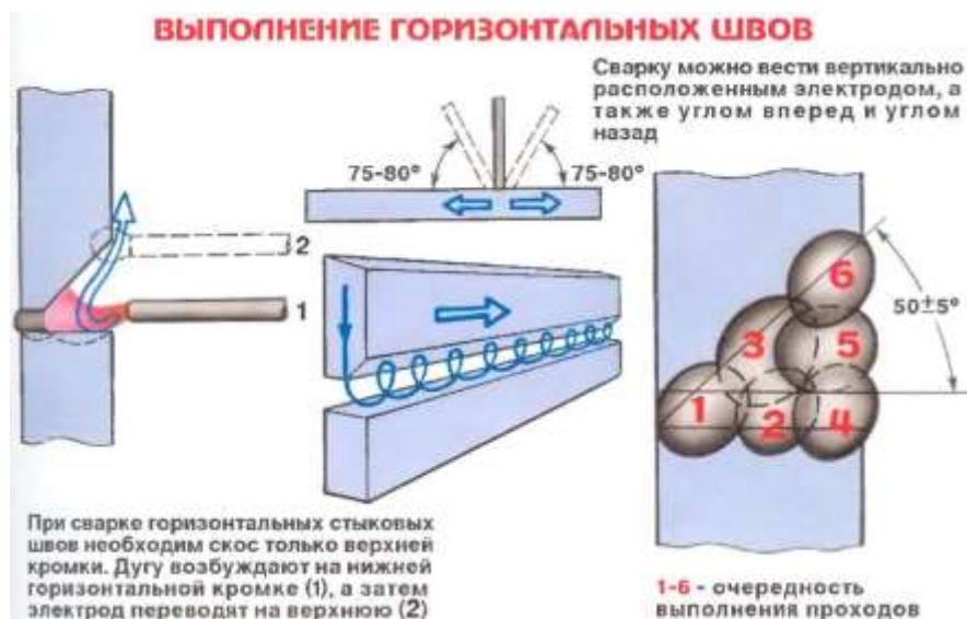
Рис.1 Техника выполнения горизонтальных швов
