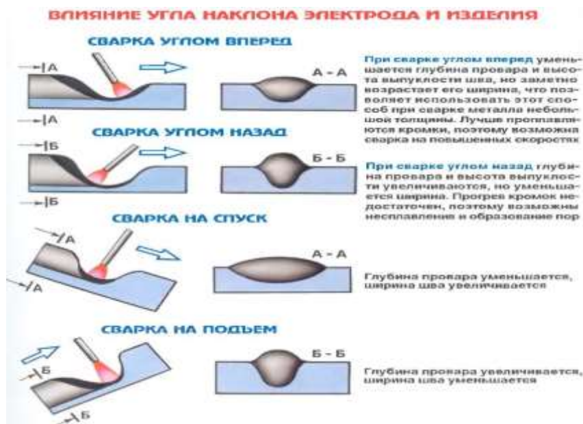
Рис.3 Положение сварочной горелки при сварке: а - вертикальное, б - углом вперед, в - углом назад (стрелкой показано направление сварки), г - выполнение первого слоя при сварке стыкового соединения, имеющего разделку кромок
