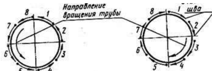
Рисунок 5 Схема сварки стыка труб большого диаметра:
