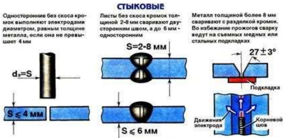
Рис.1 типы разделки кромок стыковых швов.
