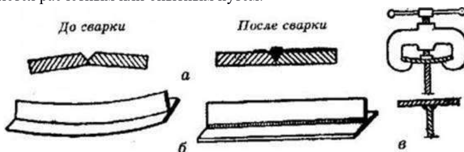
Рис. 1. Обратные деформации и положения элементов изделия после сварки: а - стыковое соединение двух пластин; б - тавровая балка; в - полка таврового соединения
