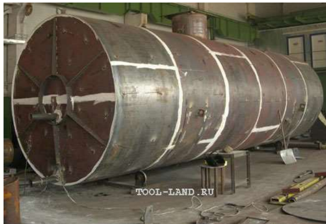
Рис.1. Цистерна, подготовленная для проверки на герметичность с использованием керосина
