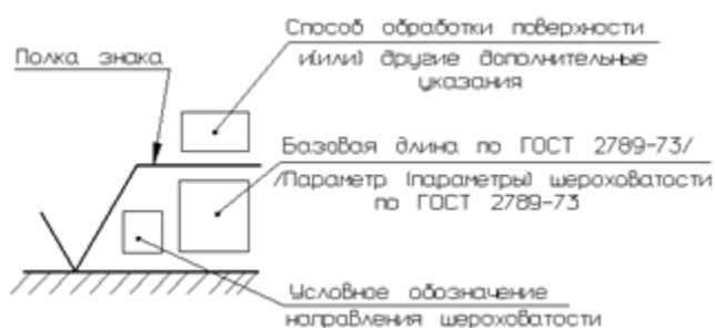
Рисунок 1- Структура обозначения шероховатости поверхности (стандарт полностью соответствует стандарту ИСО 1302)
