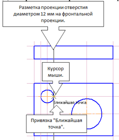
Рис. 1.8. Разметка проекции отверстия диаметром 12 мм на фронтальной плоскости.
